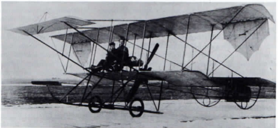
Gustav Otto und Dr. Albertini auf ihrem Otto-Doppeldecker Nr. 2 mit 50-PS-Gnôme-Umlaufmotor vor dem Start in Puchheim, 1911. – Holzbelag auf der Startbahn, weil der Boden nicht hart genug war. Repro: Archiv v. Römer
