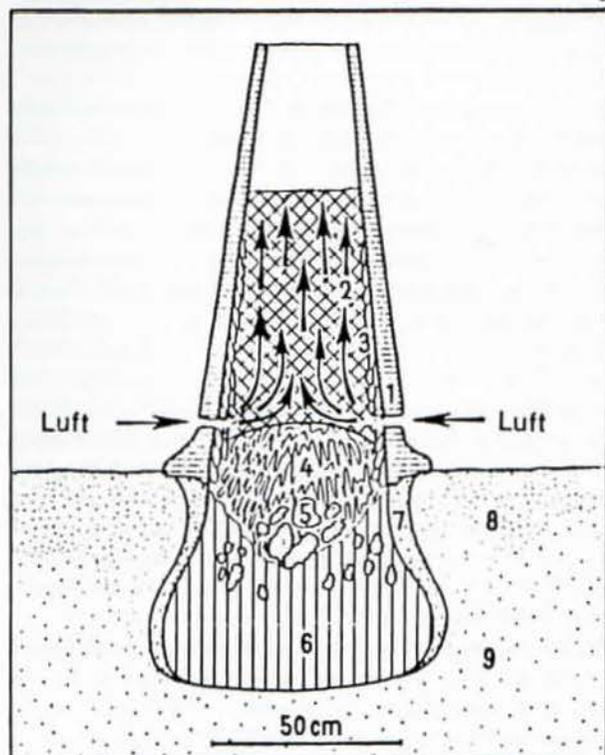
Rennfeuerofen. Rekonstruktion und Schema der Ofenfüllung am Ende des Brennvorganges. 1 Ofenmantel; 2 Gemenge aus Holzkohle, Eisenschlacke und Erz; 3 Mantelschlacke; 4 Ofensau mit eingeschlossenen Eisenstücken; 5, 6 Holzkohle mit Schlackenstückchen durchsetzt; 7 ausgeglühter Sand; 8, 9 entstehender Sand.
