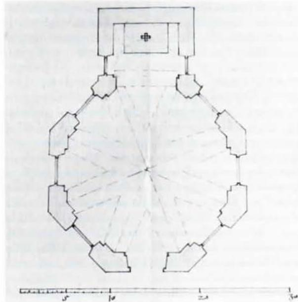
Der Bauplan von 1676 muß als Vorentwurf gewertet werden, da die im Bauvertrag erwähnten, ebenfalls 1676 entstandenen Bauteile wie Turm mit Sakristei und Oratorium sowie die »Vorhalle« noch nicht dargestellt sind.
