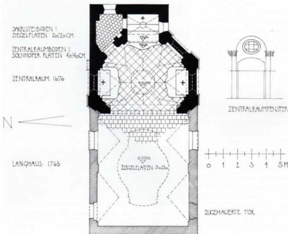
Gebäudeaufmaß des Verfassers von 1978. Schwarz dargestellt sind die Bauteile aus der Erbauung von 1676. Entgegen der bisherigen Auffassung war beim Abschlagen des Außenputzes 1980 am Mauerwerk zu erkennen, daß Zentralraum, Altarraum, Sakristei und Turm gleichzeitig errichtet wurden. Die Erweiterung von 1762/63 ist schraffiert dargestellt.
