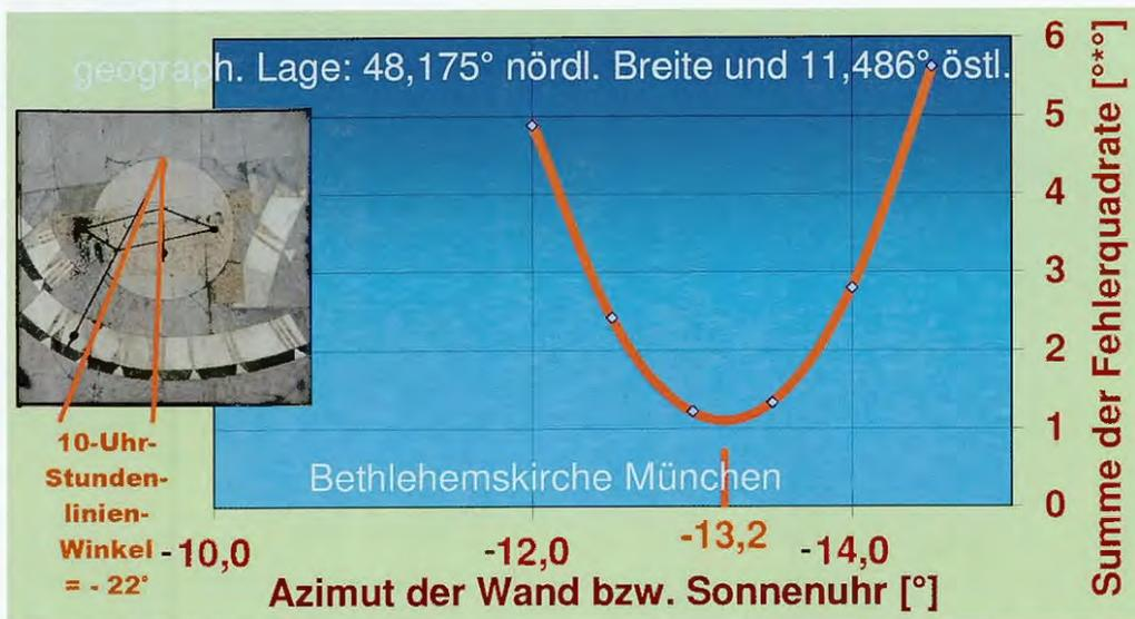
Fehlerquadratsumme der berechneten und gemessenen Stundenlinienwinkel in Abhängigkeit vom rechnerisch variierten Azimut; links ein gemessener Stundenlinienwinkel
